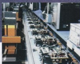
VTR組立調整ライン
